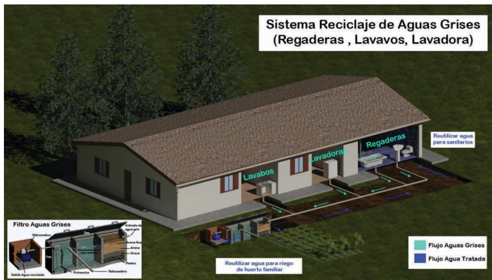
Gr fico 56: Sistema de reciclaje de agua gris
