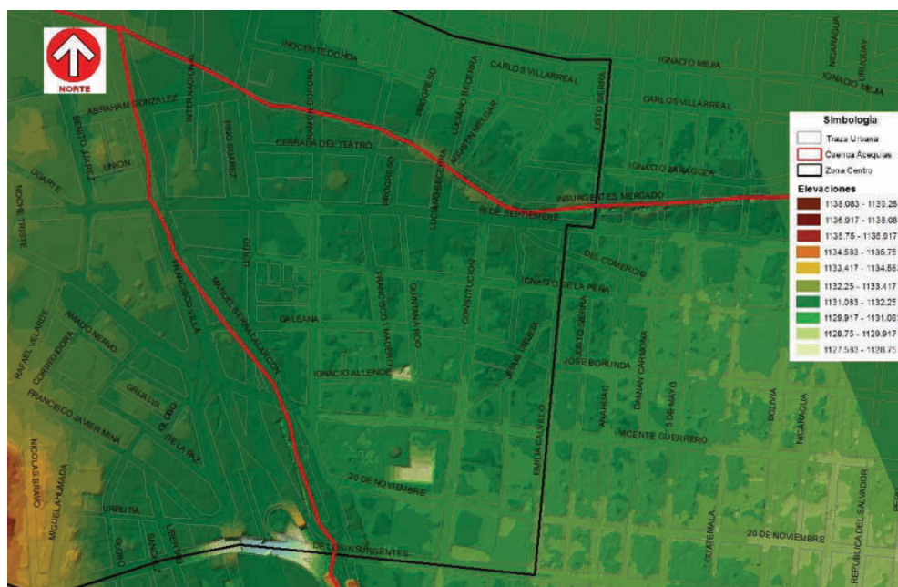
Gráfico 6. Triangulación irregular del terreno de la cuenca acequias.
